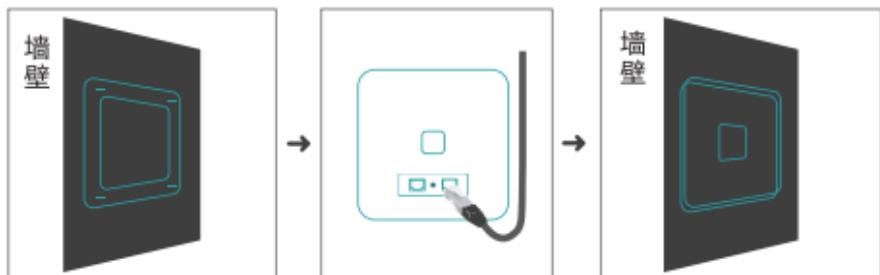
①将底盘取下，用螺丝将其固定在墙壁上；
