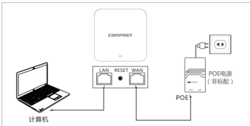
3.2 将电脑设置成自动获取IP地址，连接设备的LAN口进入设备管理界面。
