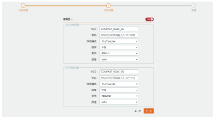
3.7 网桥模式：此模式需要桥接的上级设备开启WDS功能，AP设备可以设置内网网段(网关IP请勿与上级设备网关IP相同)，下一步选择搜索到您需要桥接的无线SSID信号名称(区分5.8GHz与2.4GHz)，输入桥接无线的密码(注意：这里的密码是上级无线WIFI的密码)
