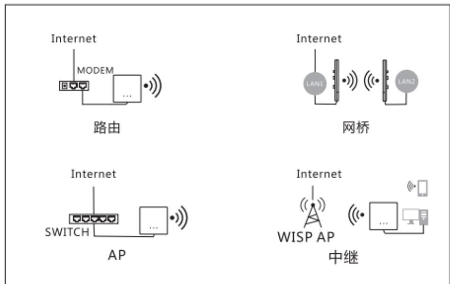
3.5 点击AP模式，为了便于管理，这里输入的IP地址和默认网关应是上级路由器的IP网段，IP地址不能和上级路由器的IP存在冲突。设置完毕后，设备的WAN口或POE电源的LAN口接入外网可以通过设置的IP地址访问管理设备。
